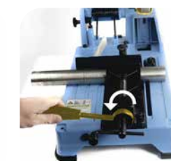
3. Nach dem Schnitt wird der Schnellspannhebel auf die linke Seite gelegt.
