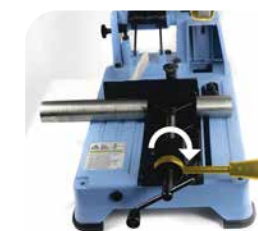
1. Ausgangsposition: Der Schnellspannhebel liegt auf der rechten Seite.
