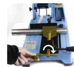
2. Schroefspindel aandraaien om het stuk te klemmen (eenmalig proces)
