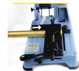
4. Stuk opnieuw in positie leggen voor de volgende zaagsnede
