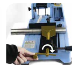
2. Das zu sägende Material wird mit der Spindel fixiert (einmaliger Vorgang).
