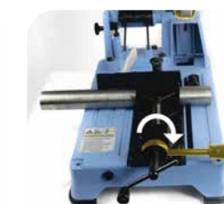
5. Hebel nach rechts und Sägevorgang starten: nächste Schritte: 3 - 4 - 5.
