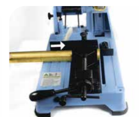
4. Das nächste Werkstück wird in die zu sägende Position gebracht.
