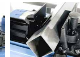
„K“ Spannvorrichtung für Vierkantrohre
