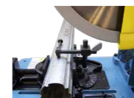
Exzentrisches Spannsystem Art.Nr. 609910
