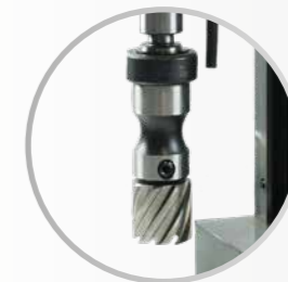
MK2 / Weldon 19 Aufnahme für einfaches Umrüsten auf Vollbohren
