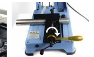
Schraubstock mit Schnellsp.-system für Serienschritte
