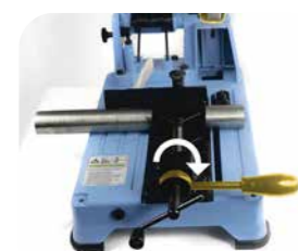
5. Hebel nach rechts und Sägevorgang starten: nächste Schritte: 3 - 4 - 5.
