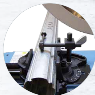
Idéal pour le sciage des tubes de volet roulant avec le système de serrage excentrique Réf. 609910
