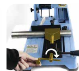
2. Verrouiller le matériau à scier avec la petite poignée (une fois par production).
