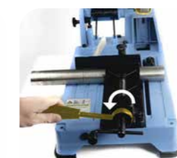
3. Après la coupe, la poignée de dégagement rapide à tourner vers la gauche.
