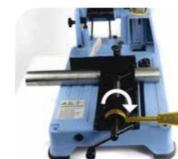
1. Position de départ: La poignée de dégagement rapide est tournée vers la droite.
