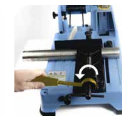
3. Na het zagen van het stuk, hendel naar links omdraaien
