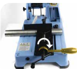
5. Snelspanhendel naar rechts omdraaien en zagen. Volgende stappen: 3 - 4 - 5
