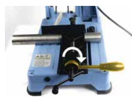
Schraubstock mit Schnellspinsystem für Serienschritte
