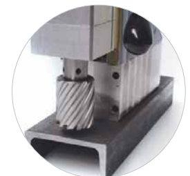
Kernbohren bis Ø 52 mm
