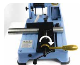
5. Hebel nach rechts und Sägevorgang starten: nächste Schritte: 3 - 4 - 5.
