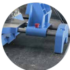
3-Punkt Arritierung Für optimale Sägeposition
