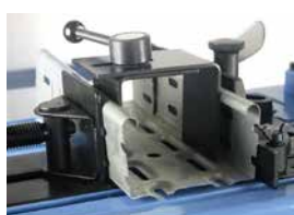
Thifix-Spannsystem für offene Profile
