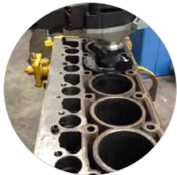
Vielseitiges Entgraten und Anfasen von Konturen, Radien und engen Bohrungen, 30°/45° Schweißnaht und Sichtkantvorbereitung etc.
