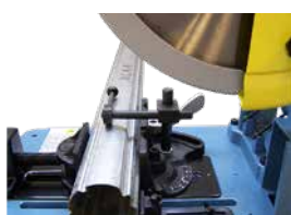
Système de fixation excentrique
