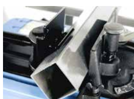
Système de serrage prismatique pour tubes carrés
