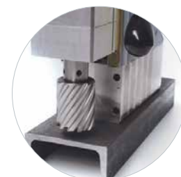
Carottage jusqu' à Ø 52 mm
