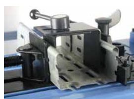
Thinfix - klemsysteem voor open profielen
