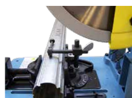
Excentrisch klemsysteem voor dunne profielen
