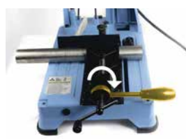
Bankschroef met snelspanstroom voor seriesneden
