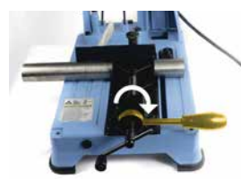
Bankschroef met snelspanstelsel voor seriesneden
